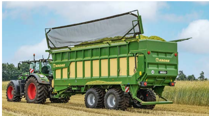
Mit zwei Zylindern können die Seitenwände optional um bis zu 68 cm abgesenkt werden. Die Laderaumsicherung ist ebenfalls optional.
