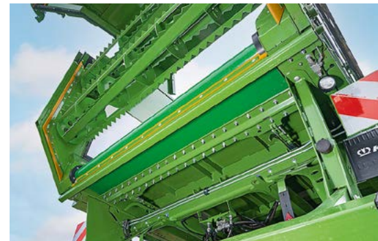
Das Band ist mit einer Leiste verschraubt. Daran sind die beiden Ketten befestigt. Das Band wird nur umgelenkt, nicht aufgerollt.
