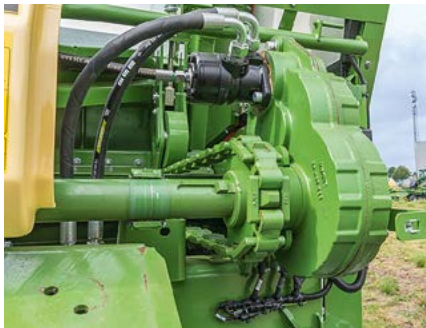
Zwei Hydraulikmotoren mit Getriebe sind mit einer Welle synchronisiert und ziehen die Ladung von oder auf den Wagen.
