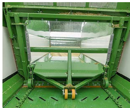
Zwei Flachgliederketten sind mit der Vorderseite der Wand über Federn gespannt und ziehen die Wand samt Band zurück in den Wagen.
