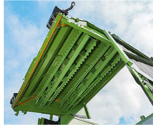
Die Dosierwalzen können mit Spannschlössern so fixiert werden, dass sie mit der Heckklappe hochschwenken. Der Wechsel dauert nur knapp eine halbe Stunde.
