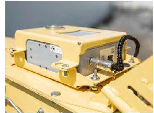
NIR-Sensoren bieten die Möglichkeit, die Inhaltsstoffe des Futters exakt zu ermitteln und den optimalen Bergezeitpunkt aufgrund des Trockenmasse-Gehalts zu bestimmen.
