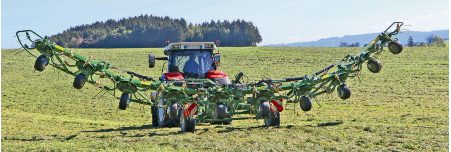
Am Vorgewende heben die Kreisel sichelförmig aus. Dafür reicht ein einfach wirkendes Steuergerät.
