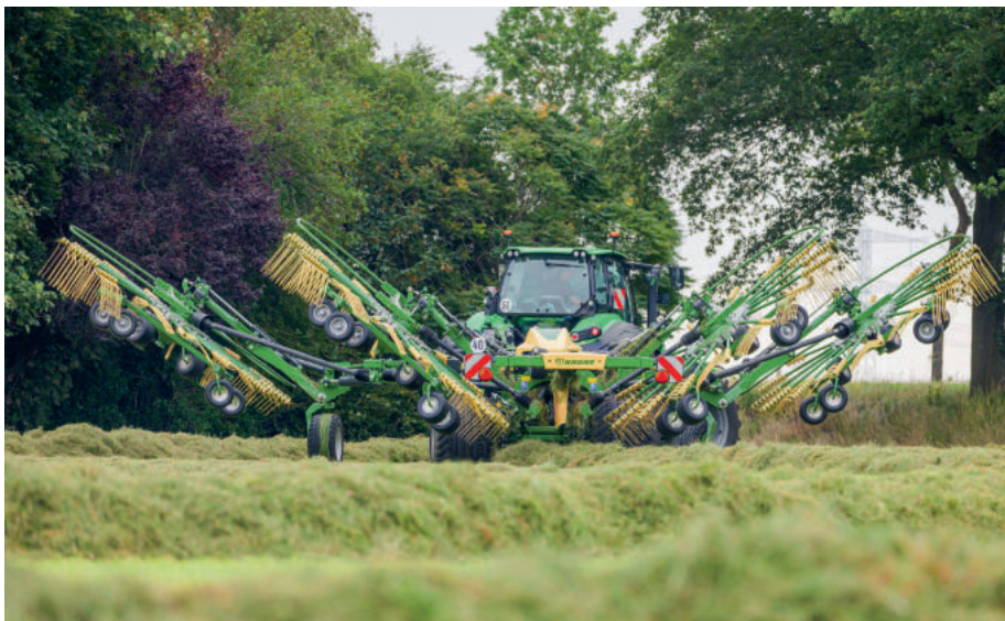
Am Vorgewende bleiben die Tasträder am Boden und nur die Arme schwenken hoch.
