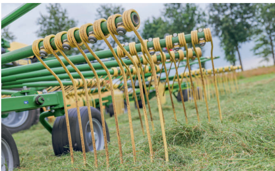
Jeder Kreisel ist mit 15 Armen ausgestattet, jedoch haben die vorderen vier, die hinteren fünf Doppelzinken installiert.
