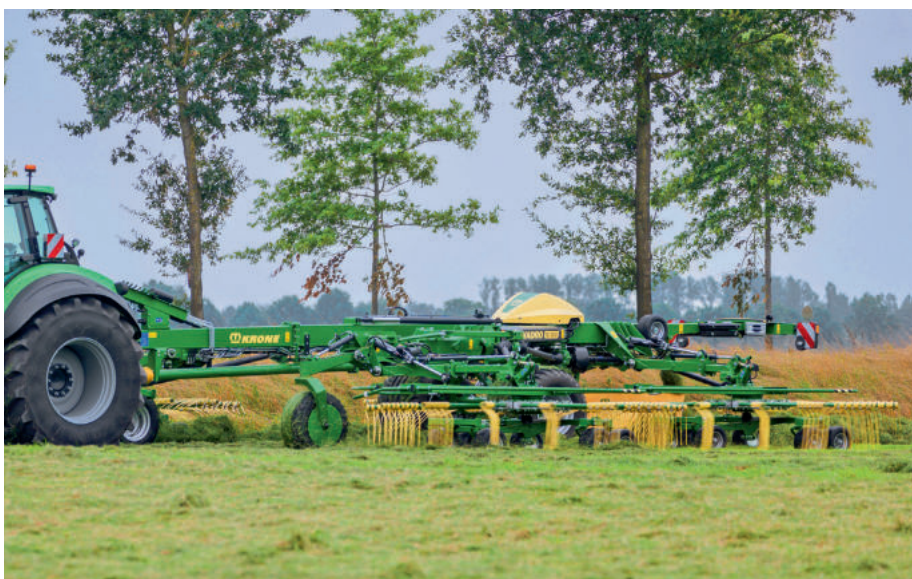
Die vorderen Kreisel drehen 25 % schneller als die hinteren.
