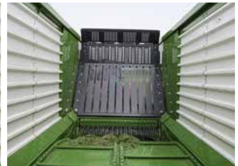
Die Stirnwand schwenkt um bis zu 100°. Damit wird der Wagen schneller leer. Und mit dem Einstellwinkel kann auf den Pressdruck im Wagen reagiert werden.
