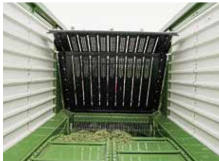
Die Stirnwand schwenkt um bis zu 100°. Damit wird der Wagen schneller leer. Und mit dem Einstellwinkel kann auf den Pressdruck im Wagen reagiert werden.
