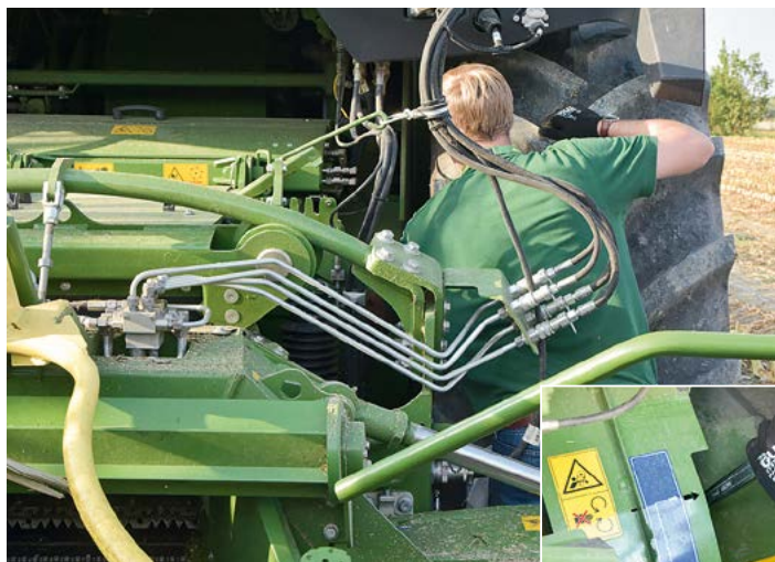
VariLOC: Einfach mit dem 36er Maulschlüssel lässt sich die Drehzahl der Häckseltrommel von 1250 auf 800 U/min reduzieren. Auf dem linken Foto auch erkennbar: der Pendelrollen-Anbaurahmen für den Erntevorsatz.
