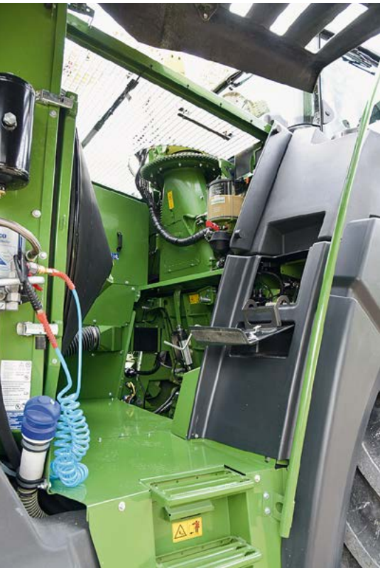
Hinter der Klappe im Kotflügel vorne rechts sitzen die Siliermittel-Dosieranlagen.
