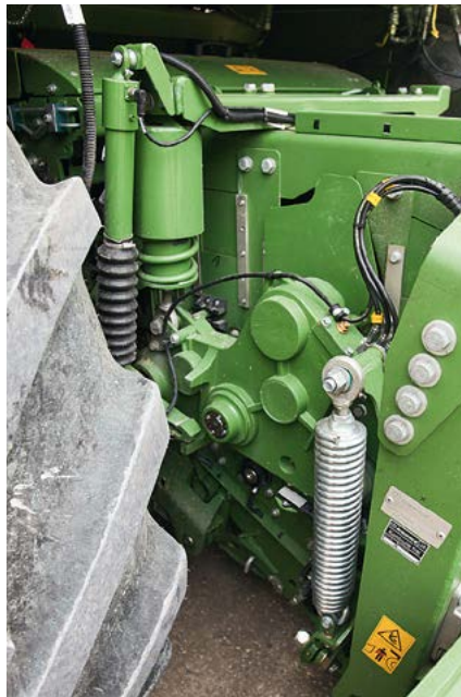
Durch die Kombination von Zug- und Druckfedern will Krone die Vorpressung verbessern.
