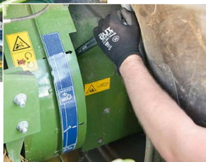
VariLOC: Einfach mit dem 36er Maulschlüssel lässt sich die Drehzahl der Häckseltrommel von 1250 auf 800 U/min reduzieren. Auf dem linken Foto auch erkennbar: der Pendelrollen-Anbaurahmen für den Erntevorsatz.
