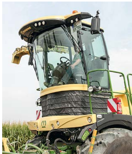
Per Tastendruck vom Sitz aus kann der Fahrer sich um 70 cm anheben lassen. Zukünftig gibt es auch eine Hinweismeldung, dass vor dem Verlassen die Kabine abzusenken ist.
