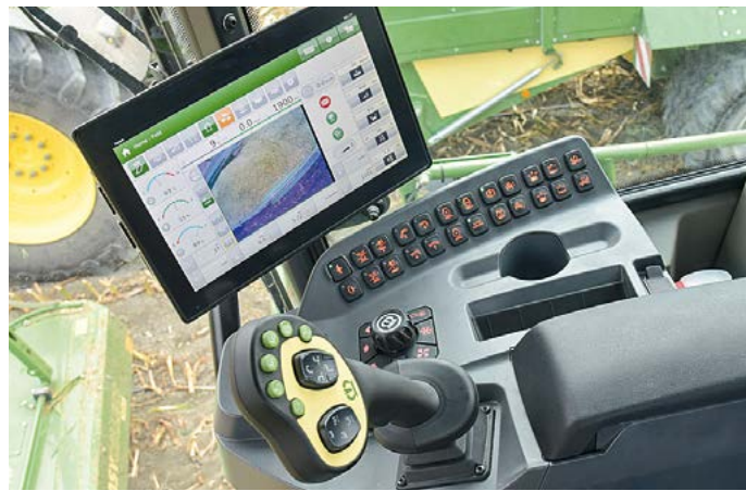
Die Instrumentenkonsolle und der Joystick stammen vom „kleinen“ BiG X. Neu ist das Terminal mit 12 Zoll großem, berührungsempfindlichem Farbdisplay.
