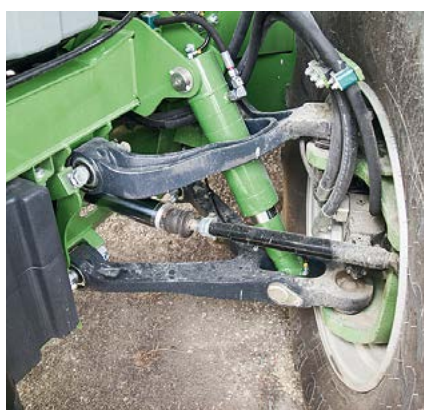
Die gefederte Hinterachse verfügt über eine Einzerradaufhängung mit oder ohne Antrieb.
