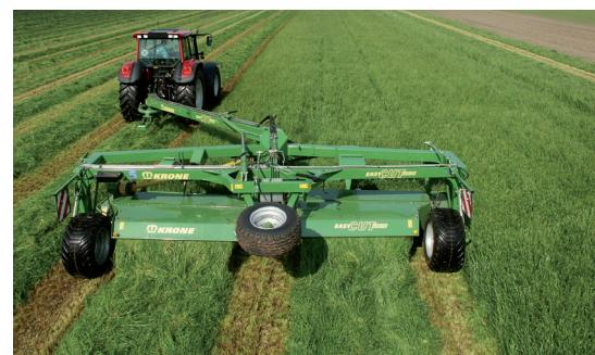
Фирма Krone предлагает также прицепные косилки с большей шириной захвата и центральным дышлом. Поэтому они могут работать справа и слева от трактора.
