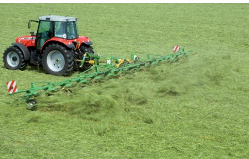
При критических погодных условиях или уборке трав на сено, после косилки должна применяться ворошилка. Она обеспечивает равномерное подсыхание.
