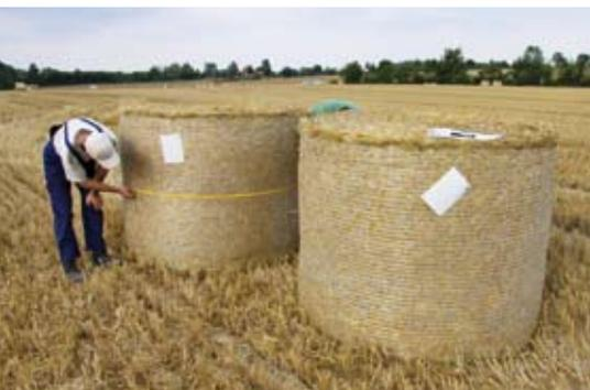
Alle Ballen haben wir mehrfach vermessen und die Kantenabdeckung beurteilt. Auftretende Unregelmäßigkeiten und Laufmaschinen wurden ebenfalls vermerkt.
