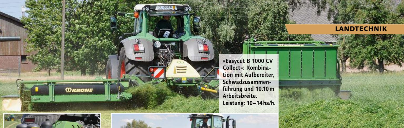
«Easycut B 1000 CV Collect»: Kombination mit Aufbereiter, Schwadzusammenführung und 10.10 m Arbeitsbreite. Leistung: 10–14 ha/h.
