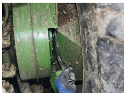
Das VariLOC wird mit einem herkömmlichen 36er Maulschlüssel geschaltet.
