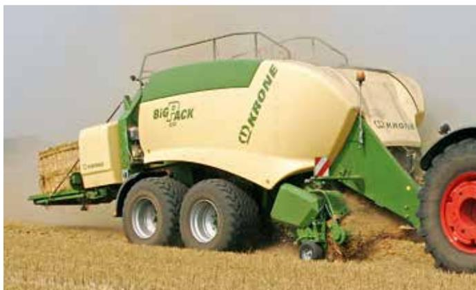
*Nous connaissons déjà le ramasseur « actif » et son rouleau d'entraînement mécanique depuis la presse « High-Speed ». L'essieu 16 t autorise des pneus de taille 710/45-26.5. Ainsi équipée la presse pèse 15,8 t et mesure 3,19 m de large.*
