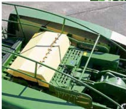
Les noueurs double Rasse ont été complètement redéveloppés, ils sont désormais plus étroits de 5 cm. En option, deux turbines centrifuges à entraînement mécanique supplémentaires s'ajoutent au système de nettoyage à air comprimé pour améliorer la sécurité du liage.
