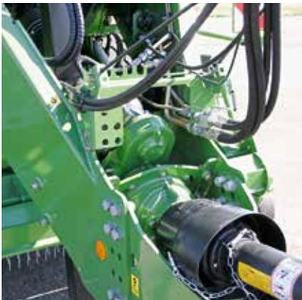
Le boîtier intermédiaire permet un transfert de la puissance de façon rectiligne. Il possède une assistance hydraulique intégrée au démarrage. En outre le régime a été augmenté de 1000 à 1180 tr/min.
