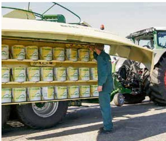
il est possible de stocker 2 x 27 bobines dans les réserves à ficelle rabattables par commande hydraulique.
