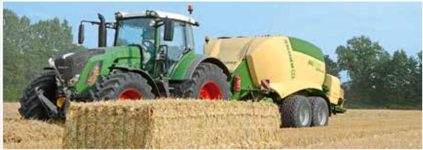
Le Fendt 939, d'une puissance de 390 CV, a effectué le parcours de test de 800 m avec la HDP II à la vitesse de 15 km/h. Toutes les 23 secondes, une balle de 2,40 m de long et pesant presque 500 kg tombait de la glissière !
