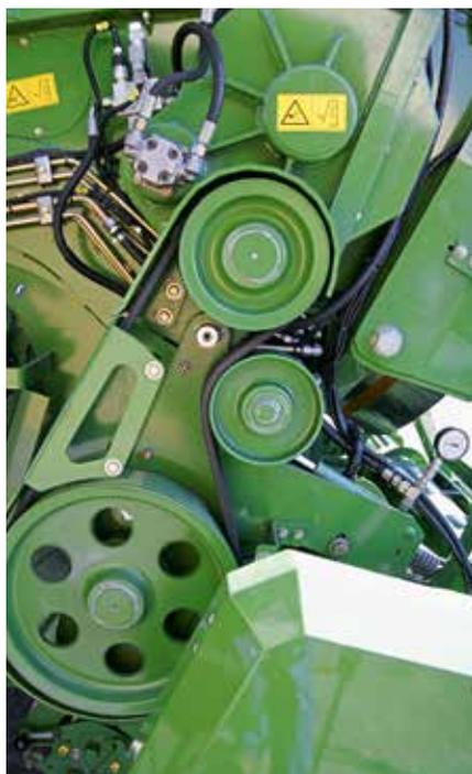
Le rotor et le ramasseur sont entraînés par une courroie et peuvent être désactivés séparément. Le patinage est contrôlé en cours de fonctionnement.
