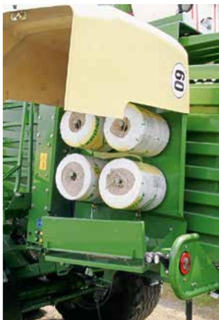
En option, il reste encore la place d'installer 2 x 6 bobines à l'arrière du canal de pressage.
