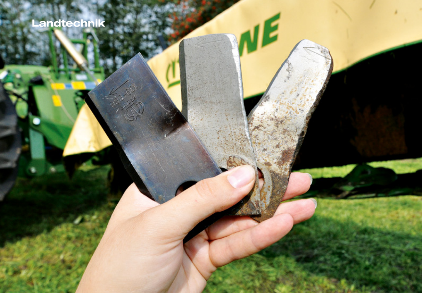
Wie wirkt sich unterschiedlicher Verschleiß an der Zapfwelle aus? Wir haben drei Mähwerksklingen verglichen.
