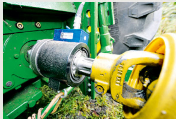
Die Drehmoment-Messnabe misst exakt die benötigte Antriebsleistung von Anbaugeräten.
