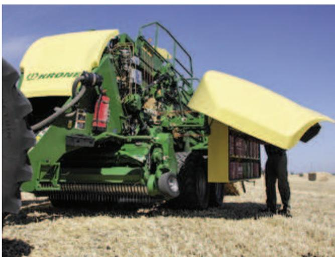
Der Garnvorrat in den seitlichen Kästen kann hydraulisch abgesenkt werden. Das verbessert auch die Zugänglichkeit.
