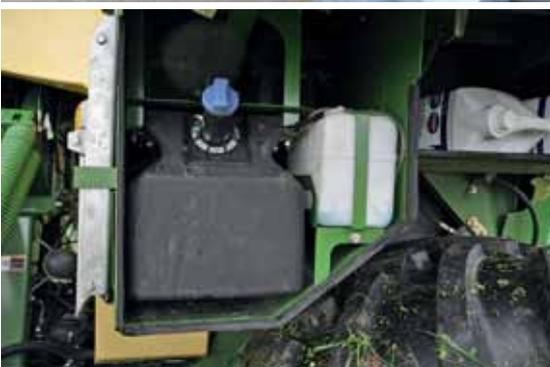
Der Motor kommt nun von MAN. Er hat ca. zwei Liter weniger Hubraum, leistet aber 20 PS mehr (links). Zur Abgasnachbehandlung setzt Krone beim BiG M 420 auf SCR mit AdBlue-Einspritzung. Der Tank dafür befindet sich auf der rechten Maschinenseite (Mitte). Krone setzt vor dem Lüfter für die Motorkühlung nun ein rotierendes Kühlersieb ein (rechts).
