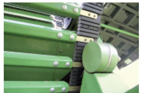
Breitere NovoGrip-Bänder, höher vergrößerte Stabhalter und verstärkte Rollbodenschrauben verbessern das Presssystem.
