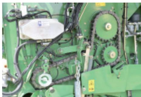
Alle X-treme-Maschinen haben verstärkte Kettenantriebe und einen größeren Ölvorrat.
