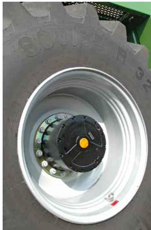
Die vorderen Reifen in der Dimension 800/65 R32 sollen in Kombination mit den Radantrieben sowie der elektronischen Anti-Schlupf-Regelung für bestmögliche Traktion sorgen.
