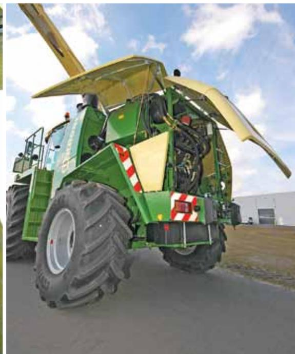
Der MAN-V8-Motor des Big X 600 erreicht gemäß Norm ECE R120 eine Leistung von bis zu 570 kW beziehungsweise 775 PS. Die Häcksel-Dauerleistung ist mit 441kW/600 PS angegeben. Damit verfügt dieses Modell über komfortable 100 PS mehr als der kleinere Bruder Big X 500.
