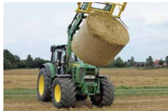
Při pádové zkoušce z výšky 2,5m se ukázaly obrovské rozdíly mezi sítími. Vybrali jsme několik balíků od každého výrobce.
