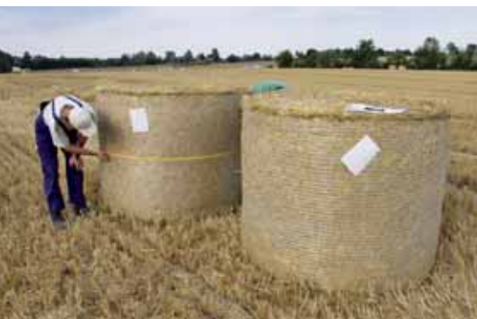
Všechny balíky jsme několikrát změřili a posuzovali i krytí hran. Zaznamenávali jsme i výskyt nepravidelností a utíkající oka.
