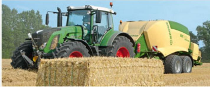
Der Fendt 939 mit 390 PS fuhr bei dem Leistungstest mit der HDP II auf dem 800 m langen Schlag rund 15 km/h. So fiel etwa alle 23 Sekunden ein 2,40 m langer und fast 500 kg schwerer Ballen von der Schurre!
