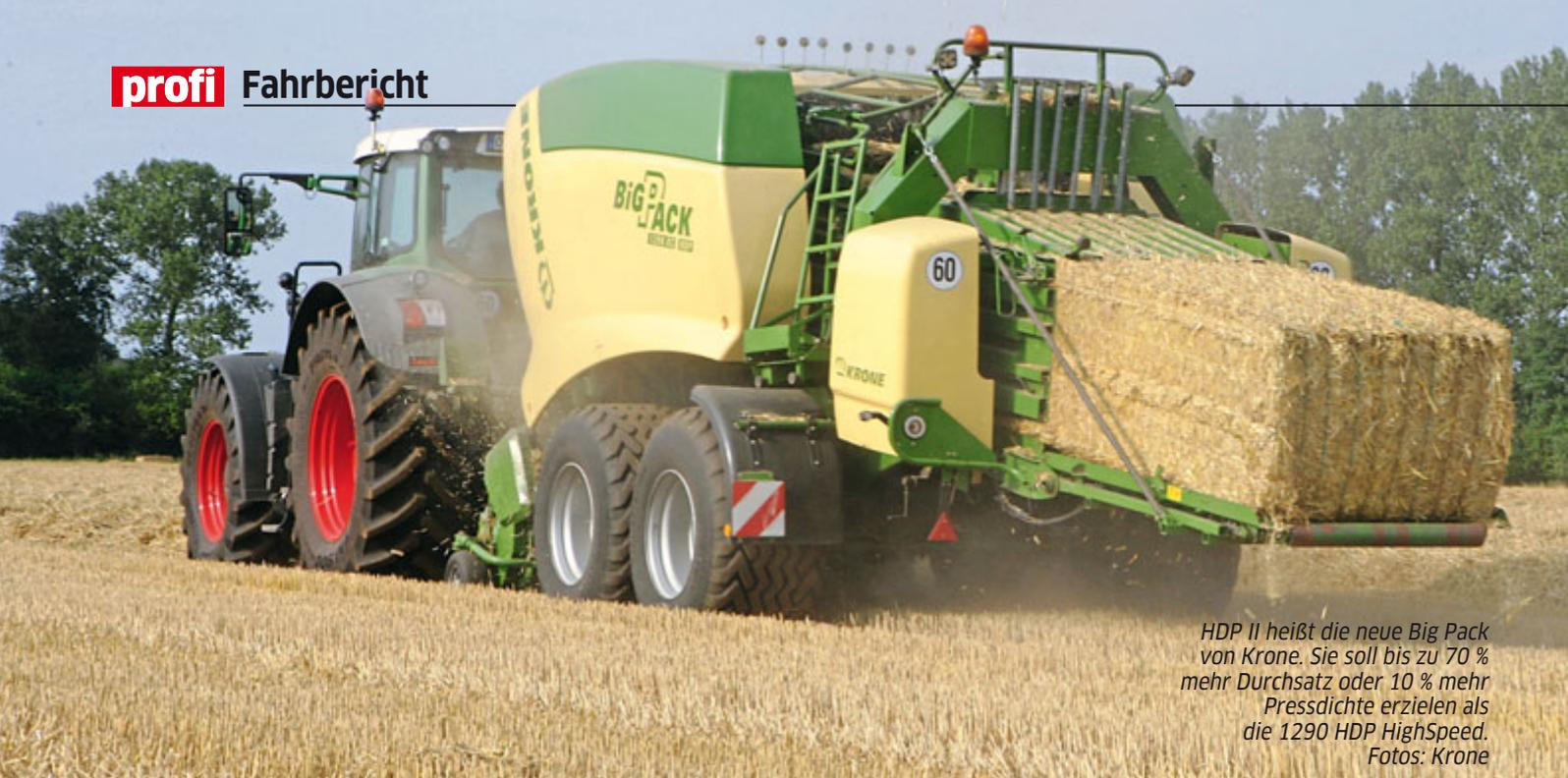
*HDP II heißt die neue Big Pack von Krone. Sie soll bis zu 70 % mehr Durchsatz oder 10 % mehr Pressdichte erzielen als die 1290 HDP HighSpeed. Fotos: Krone*
