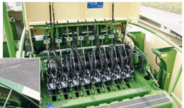
Die 8 Rassepe-Doppelknoter wurden komplett neu entwickelt und sind 5 cm schmaler. Auf Wunsch sorgen zwei mechanisch angetriebene Radialgebläse zusätzlich zur Druckluftreinigung für mehr Bindsicherheit.
