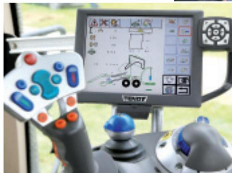
Die Ultima wird über ISOBUS bedient. Wir haben mit dem Vario-Terminal von Fendt gearbeitet.
