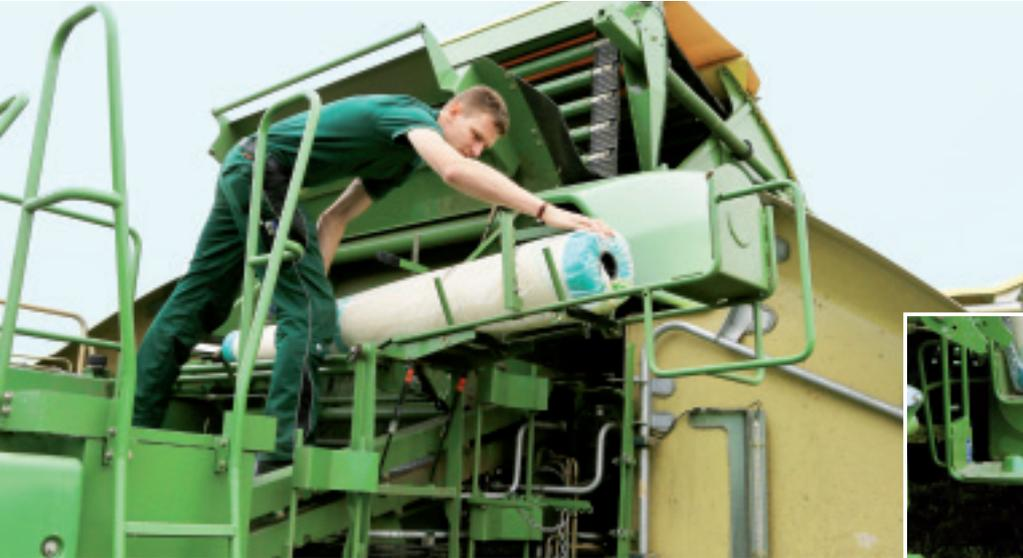
Vorne links an der Maschine können drei zusätzliche Netzrollen mitgenommen werden. Das Netz wird oben an der Presskammer eingelegt. Um die schweren Rollen dorthin zu bekommen, hat sich Krone eine pfiffige Lösung ausgedacht: eine mit Gasdruckdämpfern unterstützte Hebevorrichtung.
