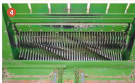
**1** Beim Öffnen der Heckklappe schwenkt eine zusätzliche Gutführungsklappe hoch. Die Dosierwalzen drehen sich mit nach oben hin abnehmender Drehzahl.
