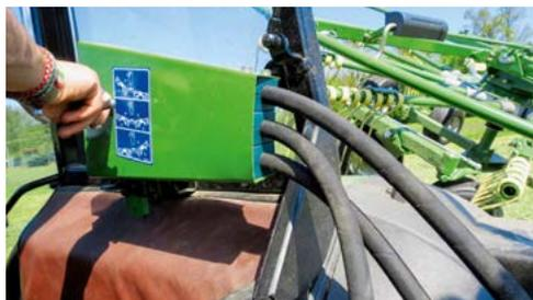
**Einfach: die Bedieneinheit für die Einzelkreiselhebung.**
