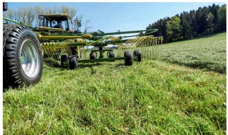
Das Tridem-Fahrwerk war bei der Testmaschine leider nur vorne mit lenkbaren Trasträdern ausgestattet.
