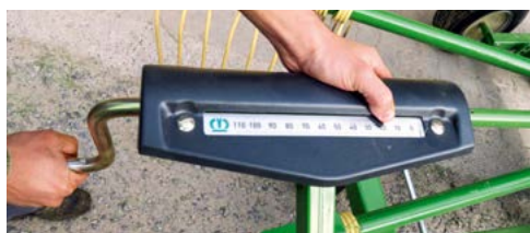
Eine gut ablesbare Anzeige erleichtert die mechanische Höheneinstellung der Kreisel.
