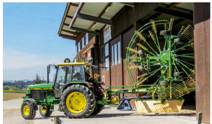
Für kleinere Remisen wird es mit der Höhe von knapp 400 cm eng. Klappbare Zinkenarme für 358 cm Höhe lohnen sich.
