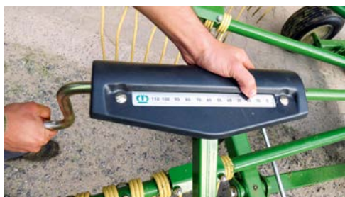
Une échelle bien visible facilite le réglage en hauteur des rotors.
