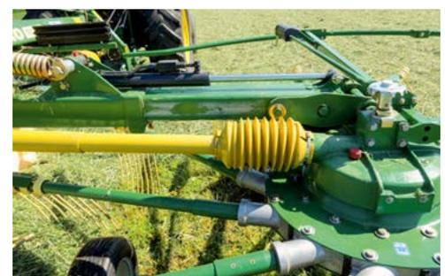
**Le réglage hydraulique de la largeur de travail permet d'obtenir des andains de 80 à 160 cm.**
