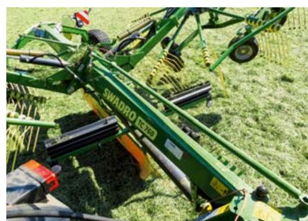
**L'essieu est autosuiveur, relié par une tringle de commande avec le bâti d'attelage.**
