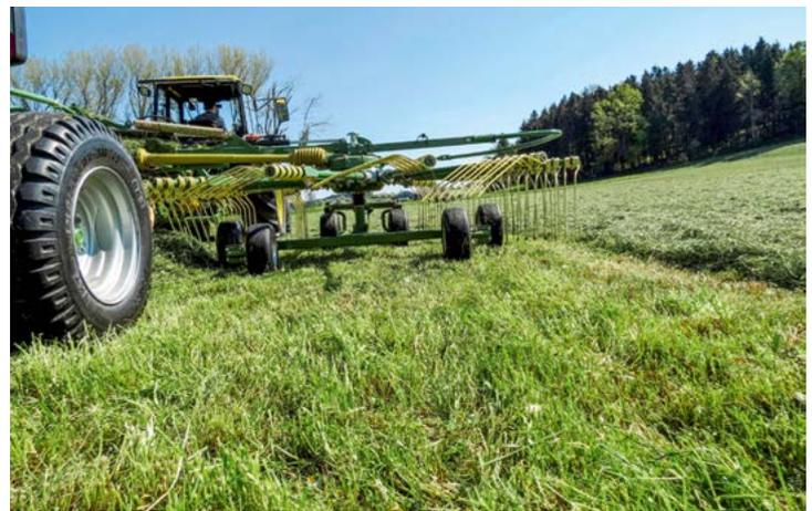
**Malheureusement, le train roulant « Tridem » ne dispose de roues orientables qu'à l'avant.**
