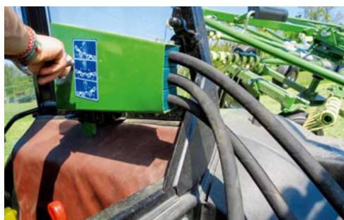
L'unité de commande du relevage des rotors est un modèle de simplicité.
