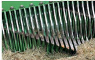
Die Stirnwand ist jetzt schwenkbar und der neue Rotor samt Räumern besteht aus Hardox.
