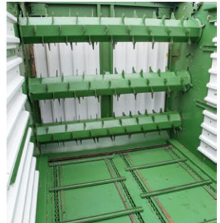
Der Kratzboden hat vier Rundstahlketten und zwei Ölmotoren mit Eilgangautomatik. Zwei Dosierwalzen sind Serie und nur am Hauptantrieb mit 2000 Nm abgesichert.
