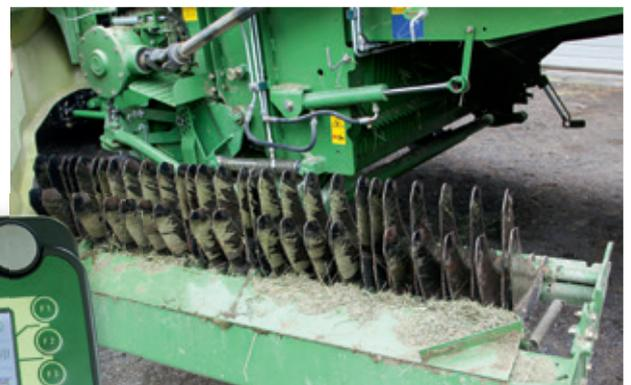
Die 46 Messer sorgen für 37-mm-Schnittlänge und können seitlich ausgeschwenkt werden. Den Schleifautomat „SpeedSharp“ gibt es laut Krone ab 2018.
