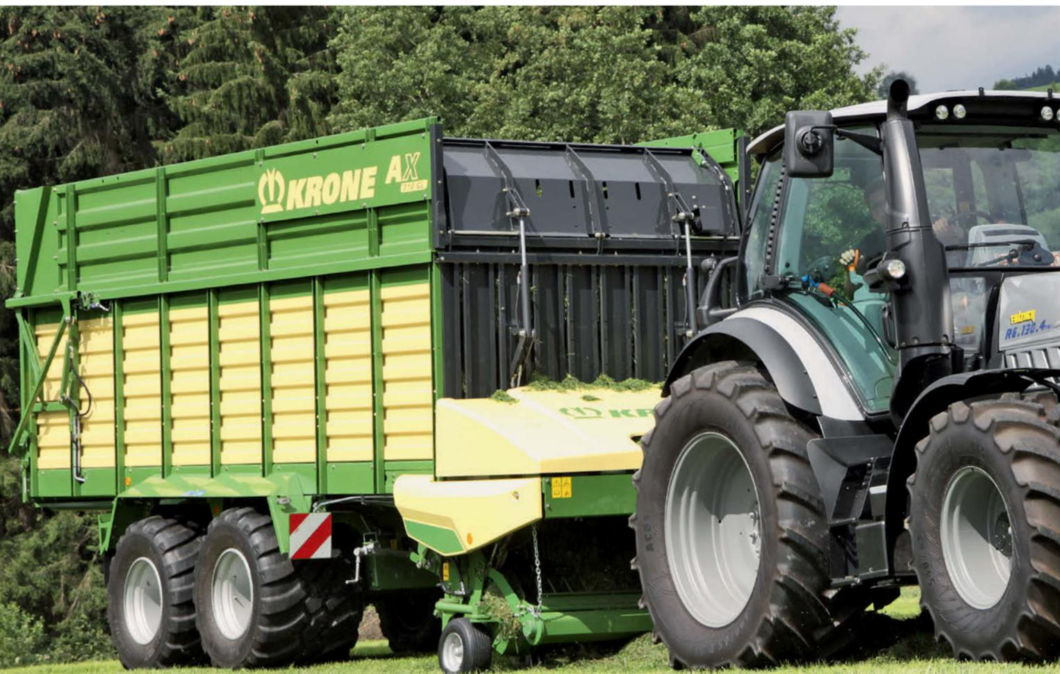
Ganzstahlhäckselaufbau, Klappe zum Anhängeln, neue Haube, abgeschrägte Kotflügel und breitere Reifen kennzeichnen die neue Generation der AX-Serie.
