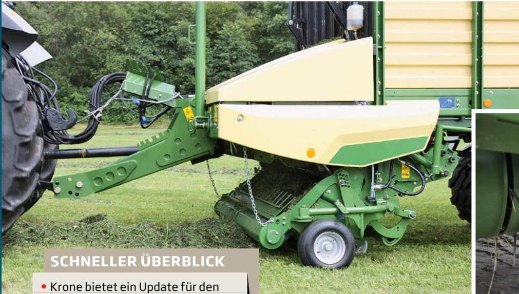
Die ungesteuerte Pick-up gibt es jetzt in W-Form angeordneten Zinken. Sie sorgt für eine gleichmäßige Beschickung des Rotors. Große Tasträder übernehmen die Tiefenführung der pendelnd aufgehängten Pick-up.
