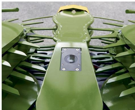
Als einziger Hersteller liefert Krone mit dem sogenannten „AutoScan“ eine automatische Schnittlängenverstellung. Hier misst ein „Auge“ den Chlorophyllgehalt. Bei anderen Herstellern muss der Fahrer die Schnittlänge manuell verstellen.
