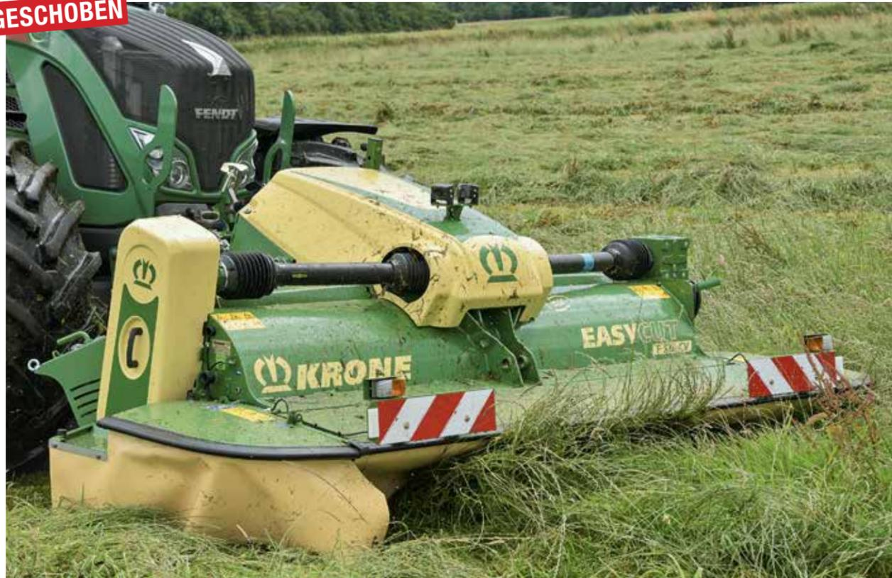
Der leichtere, geschobene Mäher braucht Freigang in den Unterlenkern und richtig eingestellte Entlastungsfedern.
