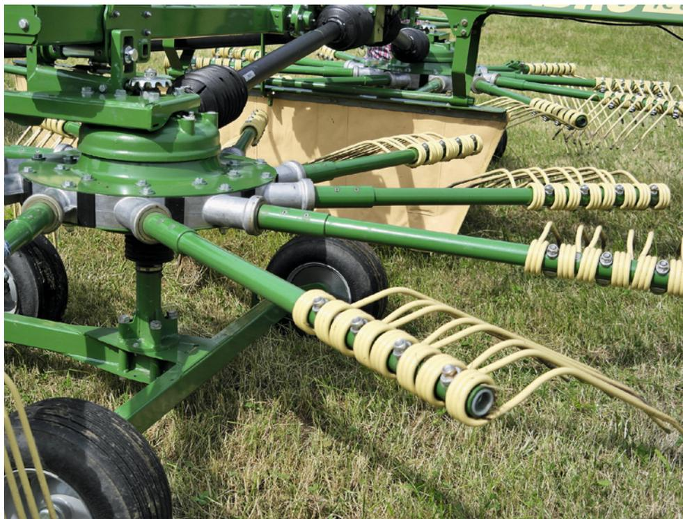
Die rundum geschlossenen Kegelradantriebe und die Zinkenarmlagerungen sind dauergeschmiert. Die Lagergehäuse sind aus robustem Aluminiumguss und spielfrei mit den Armen verbunden.
