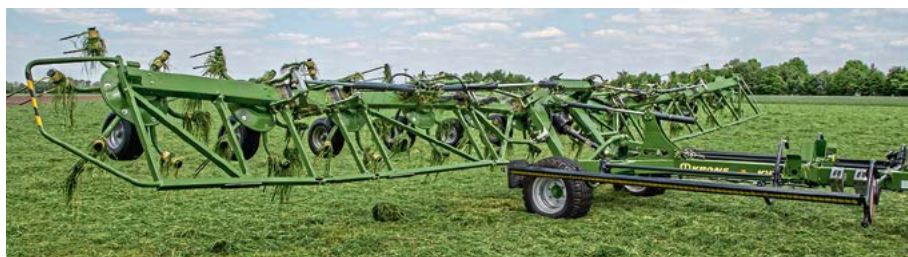
Am Vorgewende können die Kreisel mit einem ew-Steuergerät ausgehoben werden. Die Rechteckrohre dienen nicht nur dem Schutz, sondern versteifen die Maschine auf ganzer Breite.
