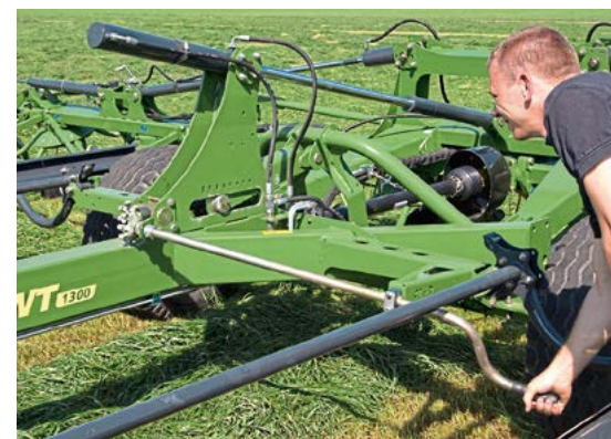
Die Reichtiefe wird per Kurbel von der Seite eingestellt. Im abgesenkten Zustand der Kreisel funktioniert das in beide Richtungen problemlos. Eine Skala dient als Orientierung.
