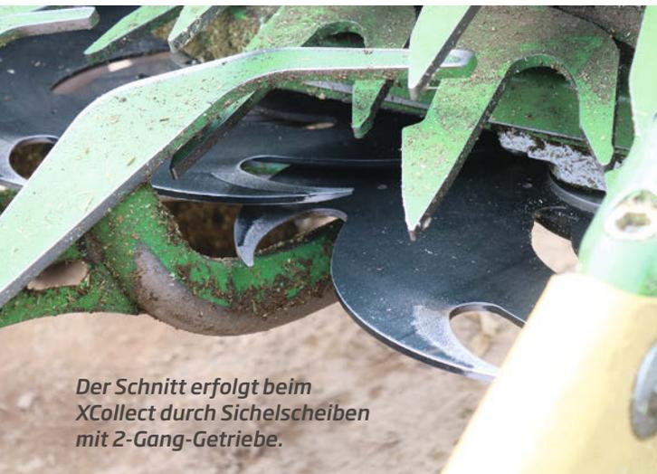
Der Schnitt erfolgt beim XCollect durch Sichelscheiben mit 2-Gang-Getriebe.
