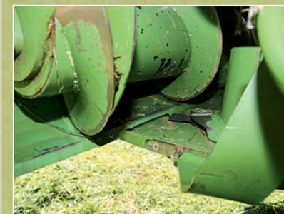
Der Förderboden schließt dicht ab. Das geänderte Antriebskonzept bietet mehr Raum.
