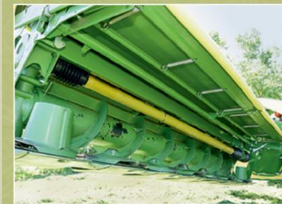
Die Gelenkwelle überträgt die Kraft für den Antrieb des Mähbalkens und der Schnecke.
