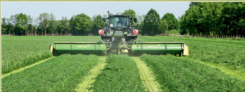
Zur Breitablage lassen sich die Förderböden hydraulisch hochschwenken. Die Schnecken überstreichen das Futter und bereiten es minimal auf. Fotos: Brüse
