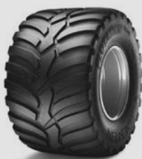
710/50 R 30.5 TL 173 D Breedte: 730 mm Diameter: 1485 mm*
