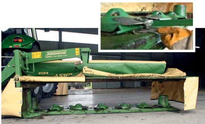
Der freitragende Schutzrahmen lässt jede Menge Platz auch bei starkem Futterbestand. Die Kraftübertragung auf das Satellitengetriebe findet nur auf der inneren Seite statt. Der Klingenwechsel erfolgt mit dem mitgeführten Werkzeug durch einfaches Unterfassen und Aufhebeln der Mäh-scheibe.
