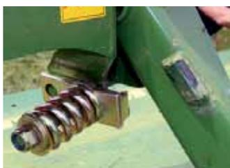
Die Anfahrtsicherung am Heckmähwerk im ausgelösten Zustand. Eine federgespannte Klinge gibt das Mähwerk bei Gegendruck nach hinten frei. Das Einrasten zurück in Arbeitsposition funktioniert gut.
