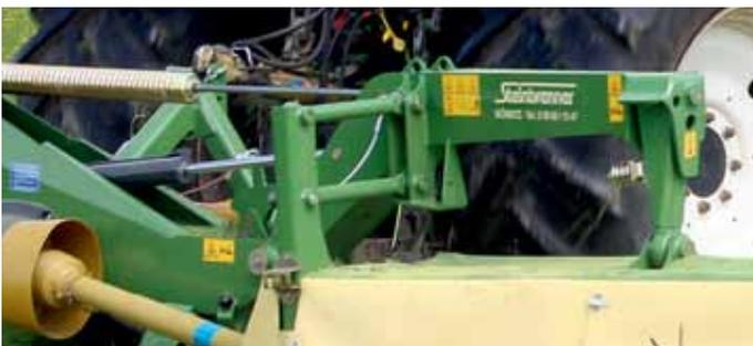
Die Aufhängung und Führung des Heckmähwerks erfolgt nach dem Prinzip DuoGrip im Schwerpunkt. Mit einem Parallelogramm werden die seitlich wirkenden Kräfte abgefangen. In Arbeitsstellung soll das Lenkerparallelogramm waagrecht zum Boden stehen.
