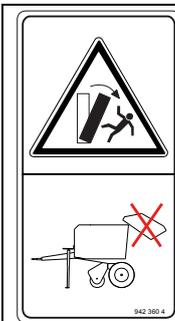
**Gefahr durch ungewollte Bewegung der Maschine beim Öffnen der Heckklappe.**
