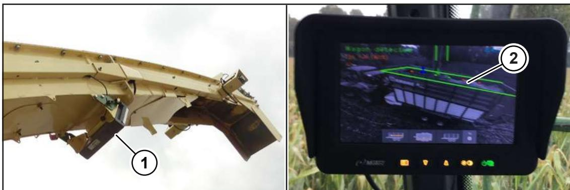
Pomocí automatické překládky se ze sklízecí řezačky automaticky naplňují přepravní vozidla. Kamera (1) namontovaná na odhadovací koncovce rozpozná přepravní vozidla a jejich stav naplnění (2). Elektronika vyhodnocuje data a otáčením doleva/doprava a pohybu nahoru/dolů nastavuje uzávěr odhadovací koncovky do příslušné polohy, aby se přepravní vozidlo kompletně naplnilo. Řidič to usnadňuje práci.
