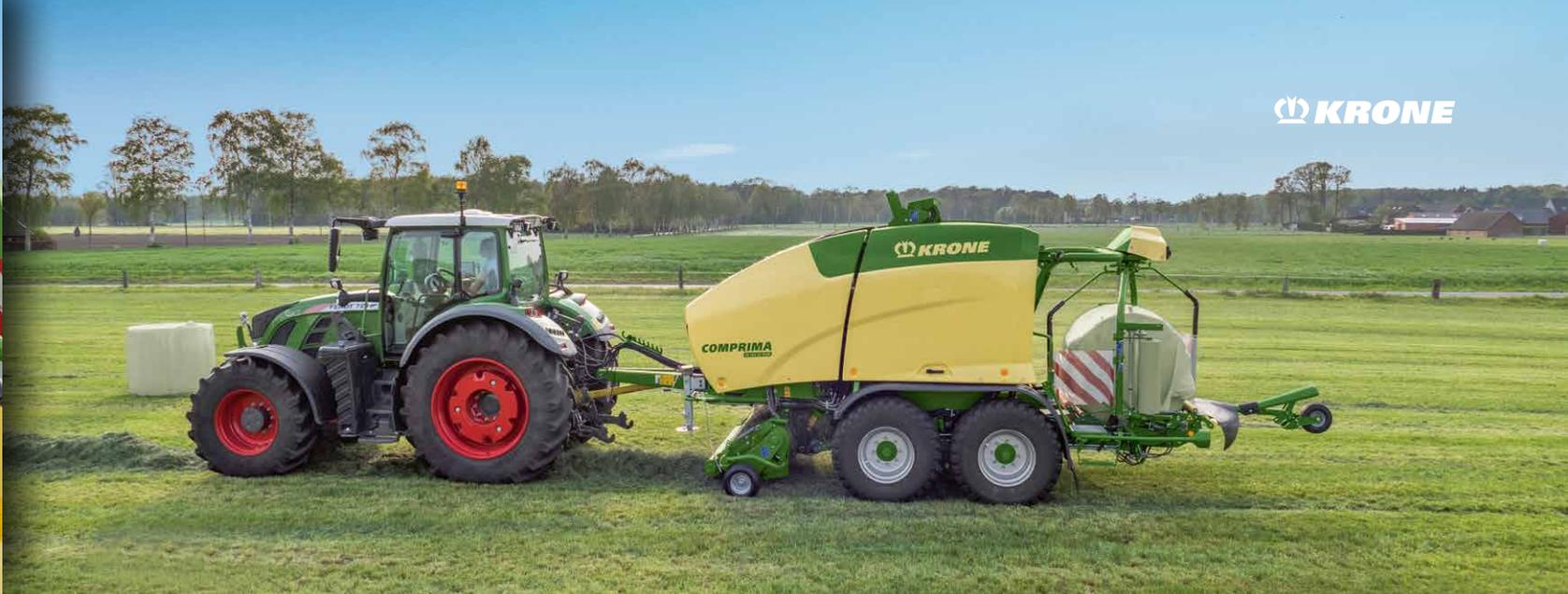
**Le combiné presse + enrubanneuse à chambre fixe et diamètre variable Comprima CF 155 Plus**
