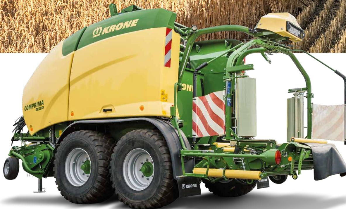
**Avec chambre fixe à diamètre variable ou entièrement variable**
