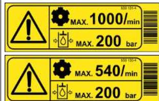
**Опасность вследствие превышения максимально допустимого числа оборотов вала отбора мощности или максимально допустимого рабочего давления.**
