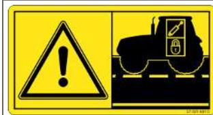
**Опасность из-за незаблокированных управляющих клапанов трактора**
