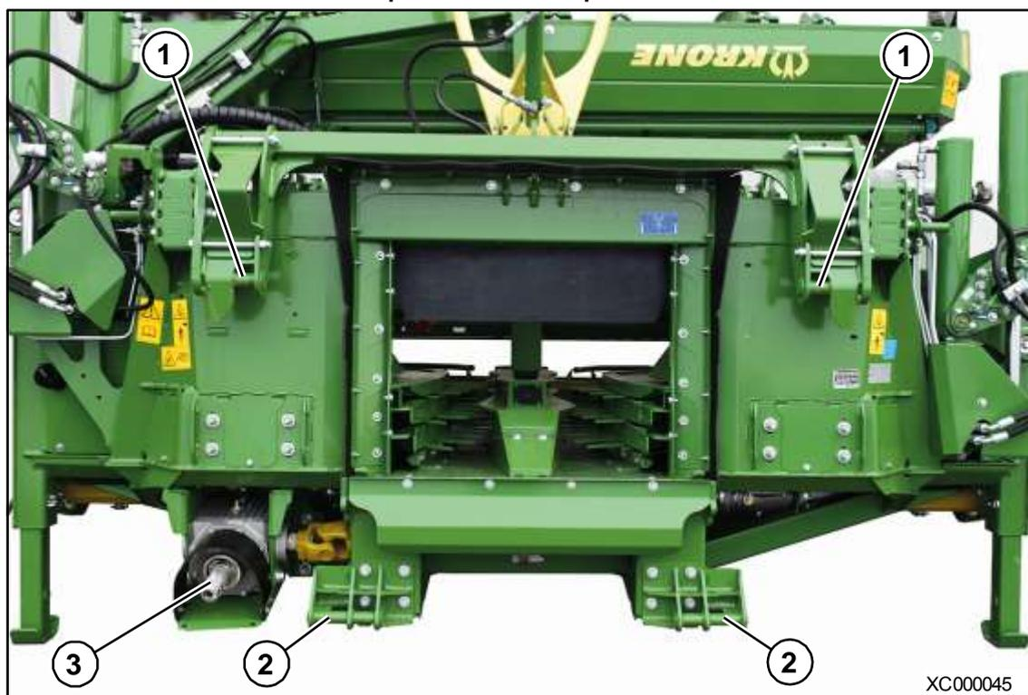
Fig. 4 Exemple : XCollect 900-3 avec adaptation du cadre pendulaire
