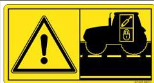
**Nebezpečí při nezajištěných řidicích ventilech traktoru**
