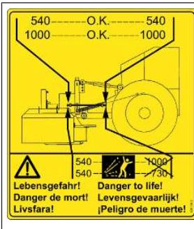
**Ohrožení života při překročení maximálního přípustného počtu otáček vývodového hřídele**
