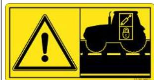
**Nebezpečí při nezavřených řídicích ventilech traktoru**
