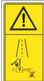
**Nebezpečí způsobené nechtěným sklopením nebo vychýlením součástí stroje**
