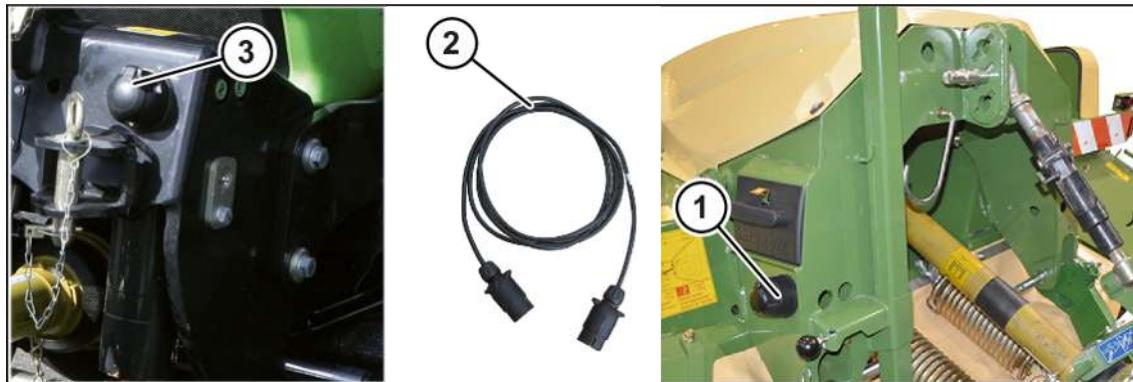
Osvětlovací zařízení pro silniční jízdu se připojí pomocí dodaného 7pólového kabelu osvětlení (2).
