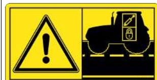
**Nebezpečí při nezavřených řídicích ventilech traktoru**
