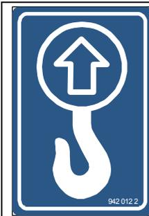
La machine comprend des points de levage identifiés par cet autocollant, voir le chapitre Conduite et transport, « Soulever la machine ».
