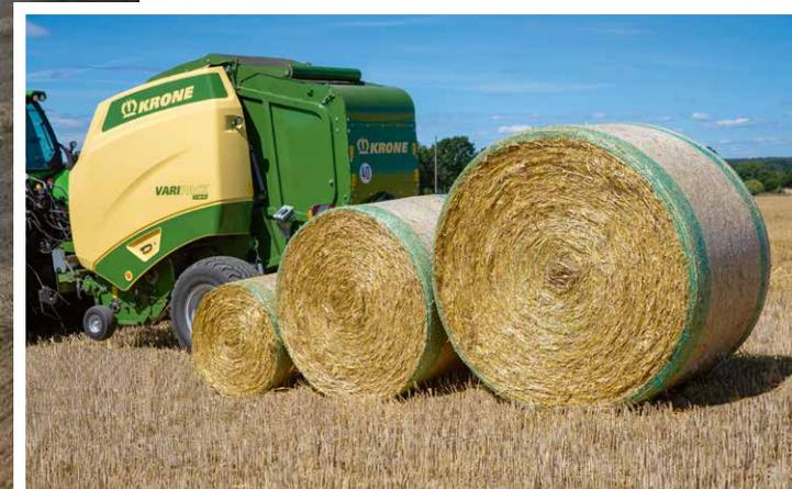
La VariPack KRONE est une presse à courroies ; elle a été spécialement conçue pour travailler les récoltes sèches. Elle se démarque par une technique simple, des débits et des densités de pressage élevés.
